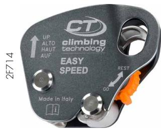
Dispositivo anticaduta progettato per l'utilizzo in lavori in quota e su fune. Conforme alle normative EN 353-2, EN 12841-A/B e alle richieste delle RFU 11.075 per l'utilizzo su piano inclinato e orizzontale su spigolo ( $r \geq 0,5$  mm). Permette la salita e la discesa su una linea verticale in tutta sicurezza bloccandosi istantaneamente in caso di caduta.
