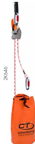
Kit di emergenza per il lavoro in quota, sviluppato per carichi di lavoro fino a 150 kg. Composto da un ancoraggio tessile (mod. Loop Ankor - 120 cm), due connettori ovali con chiusura triplex (Mod. Pillar TG), un discensore autofrenante (mod. Sparrow) ed una corda asolata (mod. Patron Plus 11).
