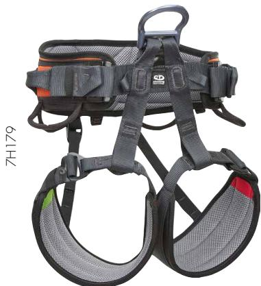
Imbracatura bassa ergonomica provvista di due punti di attacco laterali in fettuccia, di uno ventrale in lega leggera e di uno posteriore in fettuccia. Combinata con il pettorale Top Y dà origine ad un'imbracatura completa EN 361. Struttura avvolgente e leggera con imbottitura in mesh traspirante per un comfort ottimale.
