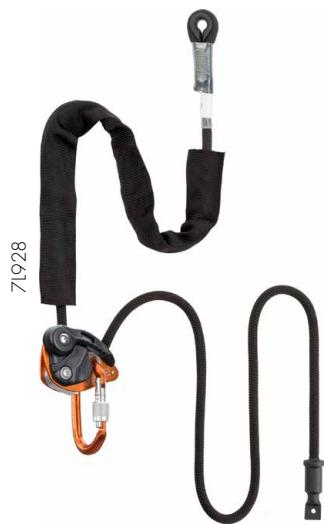
Cordino multiuso per lavoro in quota. Certificato per l'utilizzo come cordino regolabile di posizionamento sul lavoro EN 358, ancoraggio provvisorio EN 795-B e linea di vita orizzontale EN 795-C. Il dispositivo è inoltre conforme a tutte le richieste della normativa EN 12841-C per l'utilizzo come discensore ad eccezione dei punti 4.1.2 e 4.1.3 che non sono stati presi in considerazione.
