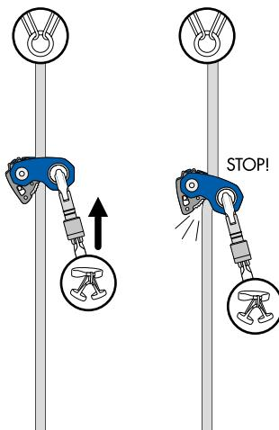
Permette la risalita di una corda in conformità alle norme EN 567 / EN 12841-B.
