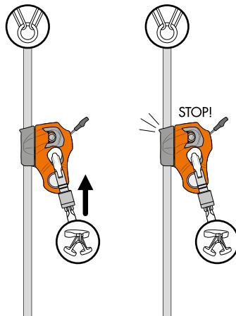
Permette la risalita di una corda in conformità alle norme EN 567 / EN 12841-B.
