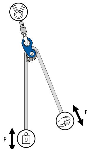
Grazie alla possibilità di bloccare la camma, può essere utilizzato come carrucola semplice per il sollevamento o il trasferimento di un carico in conformità alla norma EN 12278.
