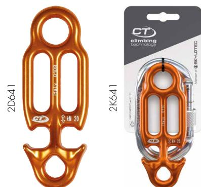
Discensore/assicuratore multiuso progettato per la discesa in corda doppia e il recupero autobloccante dei secondi. Dotato di due fori: quello superiore per l'ancoraggio e quello inferiore per l'aggancio alla longe per la discesa in corda doppia.
