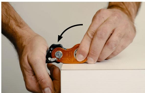
Con una mano sujetar el dispositivo por la parte del orificio de conexión. Con la otra mano girar hacia el exterior la leva y con la palma de la mano apretar con fuerza hacia abajo. Suelta la leva.
