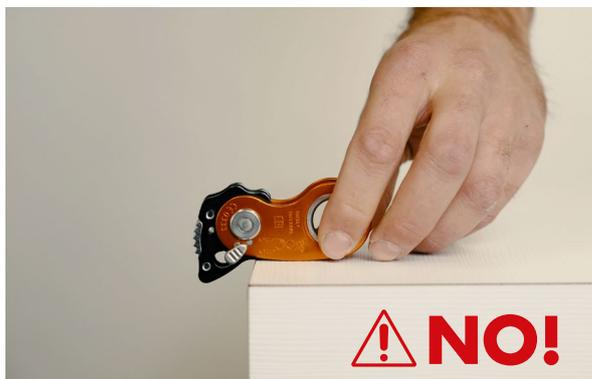
Si la leva supera el perno presente en el flanco y se queda bloqueada en esa posición, significa que el producto es defectuoso: en este caso, el dispositivo no se puede utilizar y debe devolverse a la empresa.
