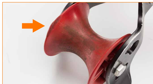
Puleggia deformata sul bordo esterno.
