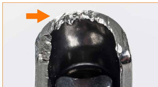
Corpo con zone di entrata/uscita della corda taglienti: pericolo di danneggiamento della corda!
