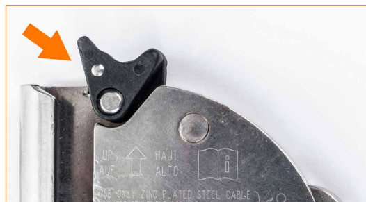
Levetta di sicurezza che non ritorna in posizione autonomamente.
