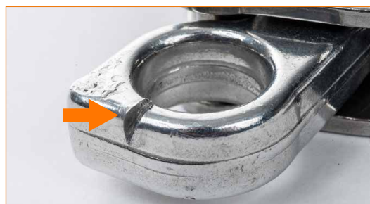
Leva di bloccaggio con evidente fessurazione.
