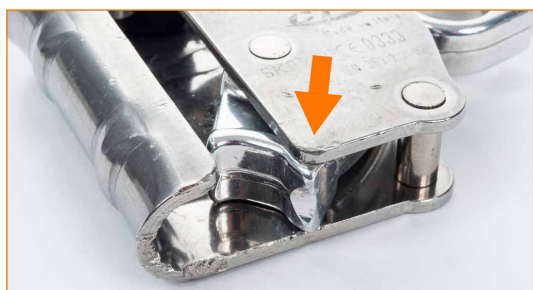
Corpo deformato che ostacola l'apertura della leva di bloccaggio.
