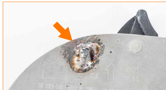
Signe de soudure à proximité du rivet.
