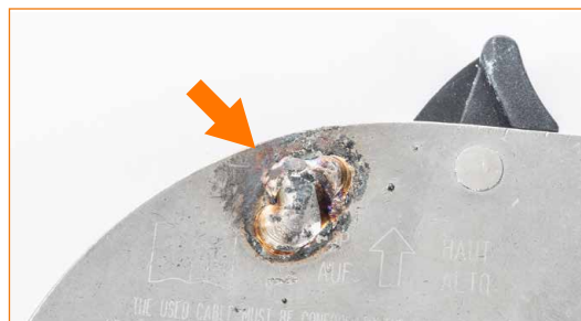
Marca de soldadura cerca del remache.
