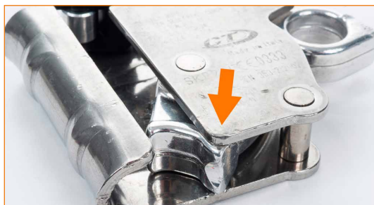
Palanca de bloqueo doblada.
