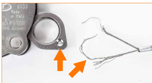
Cable de conexión roto.
