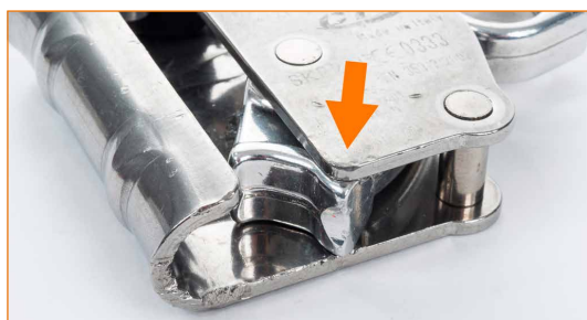
Cuerpo deformado que estorba la apertura de la palanca de bloqueo.
