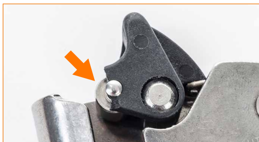
Palanca de seguridad dañada.
