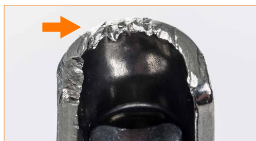
Cuerpo con zonas de entrada/salida de la cuerda afiladas: riesgo de daños a la cuerda!
