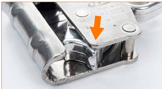
Eine Verformung am Körper verhindert die Öffnung des Klemmhebels.
