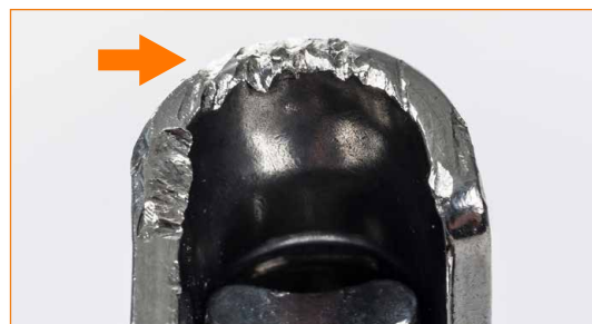
Scharfe Kanten an der Seileintritt- und Austrittsstelle am Körper: es besteht die Gefahr auf Seilschädigung!
