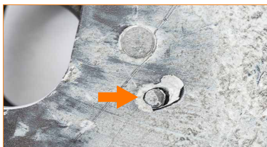
Deposito di materiale duro nella cavità presente sul retro del dispositivo.
