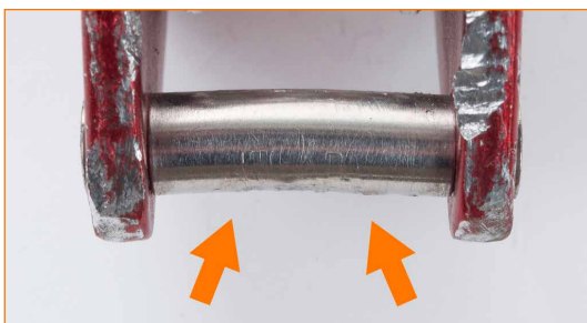
Axe de connexion aux joues déformé.
