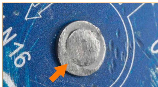
Corps présentant un signe d'usure évident à proximité de l'axe de rotation.
