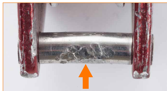
Axe de connexion aux joues détérioré.
