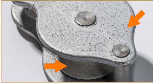
Corps et réa complètement oxydés.
