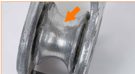
Réa usé en un seul point à cause du passage d'un câble métallique sur le réa bloqué (utilisation incorrecte).
