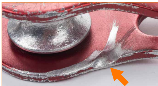
Corps présentant un signe d'usure évident à l'intérieur.
