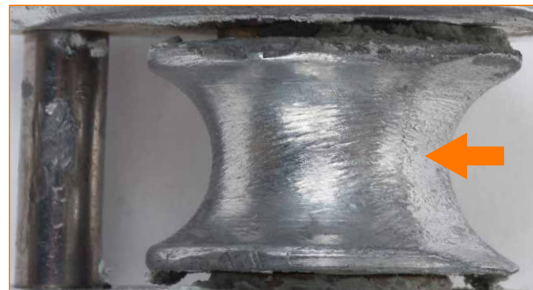
Réa usé en un seul point à cause du passage d'un câble métallique sur le réa bloqué (utilisation incorrecte).
