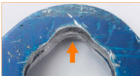
Corps présentant un signe d'usure évident à proximité des trous de connexion.
