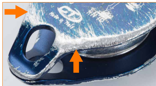
Corps présentant un signe d'usure évident sur les bords extérieurs.
