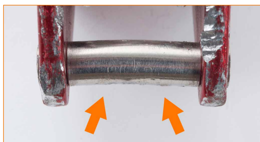
Perno de conexión de las placas laterales deformado.
