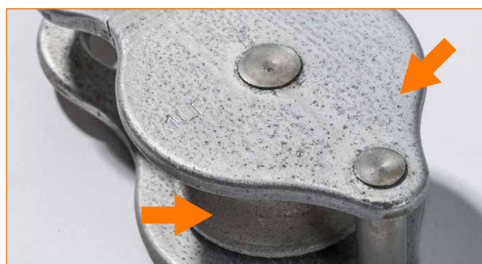
Cuerpo y roldana completamente oxidados.
