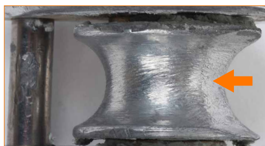
Roldana desgastada en un solo punto por el deslizamiento de un cable metálico por encima de la roldana bloqueada (uso incorrecto).
