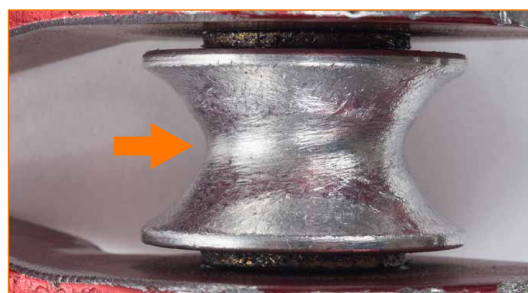
Roldana extremadamente desgastada hasta que se nota un cambio en el perfil de la garganta.
