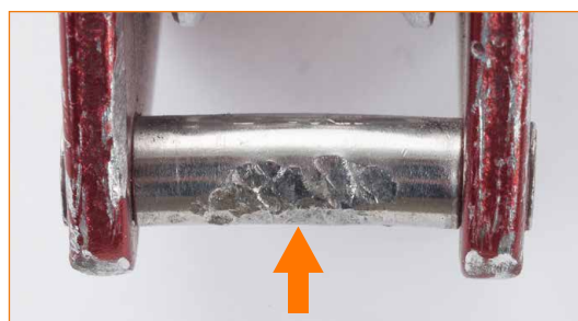
Perno de conexión de las placas laterales dañado.
