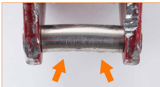
Verformter Verbindungsstift der Wangen.
