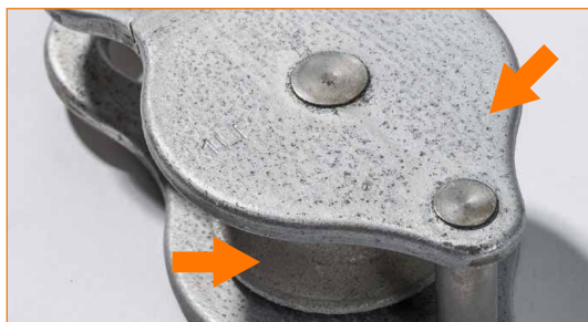
Gerätekörper und Riemenscheibe vollständig oxidiert.
