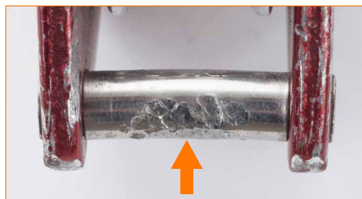
Beschädigter Verbindungsstift der Wangen.
