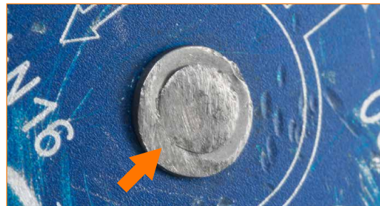
Gerätekörper mit offensichtlicher Abnutzungserscheinung in der Nähe des Drehstifts.
