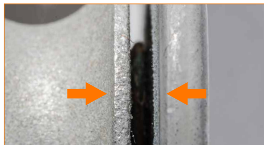
Gerätekörper und Riemenscheibe vollständig oxidiert.
