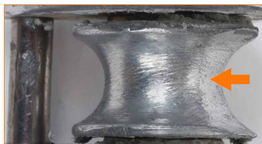
An einem Punkt verschlissene Riemenscheibe, wegen Durchlauf auf Metallseil mit blockierter Riemenscheibe (fehlerhafte Verwendung).
