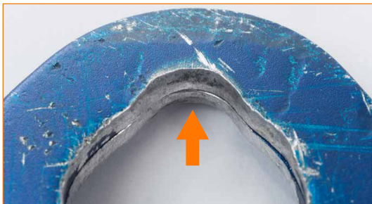
Gerätekörper mit offensichtlicher Abnutzungserscheinung in der Nähe der Anschlagöffnungen.
