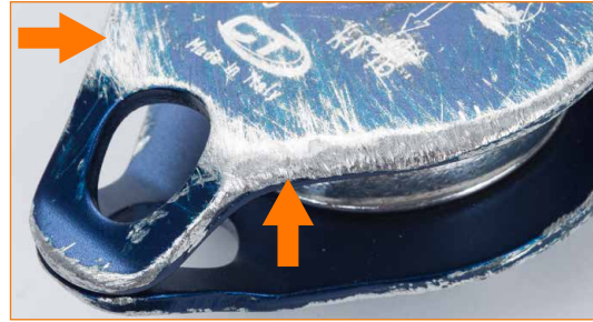
Gerätekörper mit offensichtlicher Abnutzungserscheinung an den äußeren Rändern.
