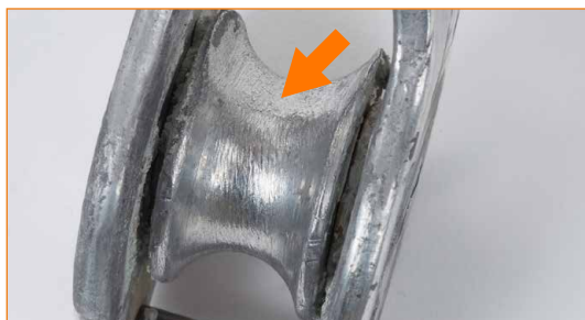
An einem Punkt verschlissene Riemenscheibe, wegen Durchlauf auf Metallseil mit blockierter Riemenscheibe (fehlerhafte Verwendung).
