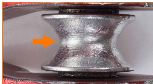
Äußerst abgenutzte Riemenscheibe, im Profil der Rille ist eine Änderung erkennbar.
