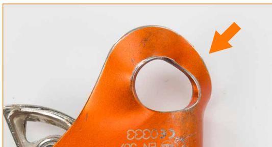
Verformter und abgenutzter Körper.
