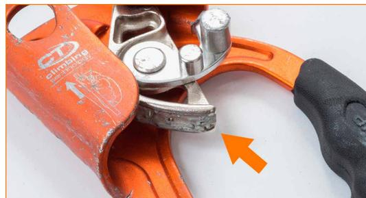
Klemmnocke und/oder Sicherheitshebel kehren nicht automatisch in die Ausgangsposition zurück.
