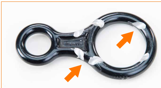
Ohne Erlaubnis außerhalb der Produktionsstätte abgeändertes Gerät (Einschnitte von über 1 mm).
