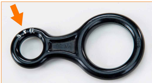
Gerät mit offensichtlichen Verschleißanzeichen (mehr als 1 mm)
