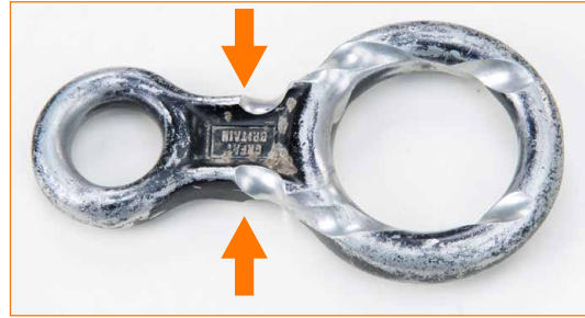
Gerät mit offensichtlichen Verschleißanzeichen (mehr als 1 mm)
