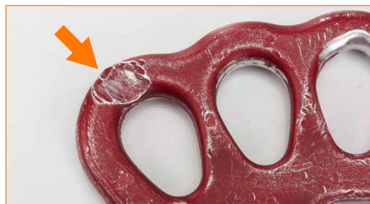
Corpo con segni d'incisione con profondità superiore ad 1 mm.
