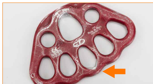
Segni di usura con profondità superiore ad 1 mm.
