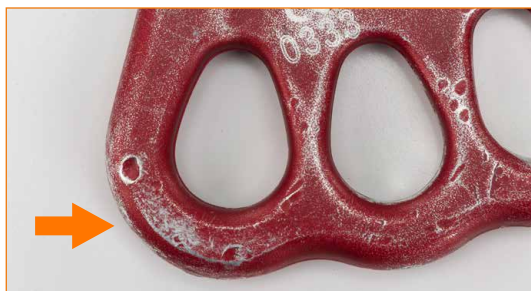
Corpo con segni d'incisione con profondità superiore ad 1 mm.
