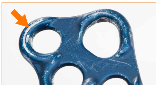
Segni di usura e incisioni con profondità superiore ad 1 mm.
