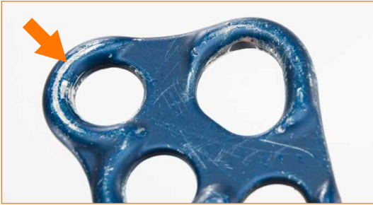
Abnutzungserscheinungen und kerben mit einer Tiefe von mehr als 1 mm.
