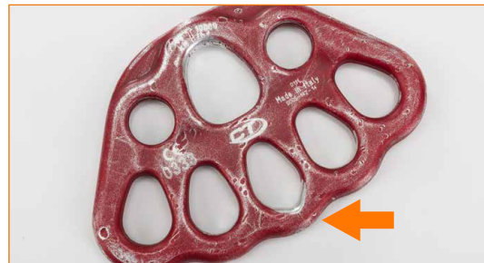
Abnutzungserscheinungen mit einer Tiefe von mehr als 1 mm.
