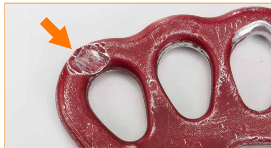
Körper mit Einkerbungen mit einer Tiefe von mehr als 1 mm.
