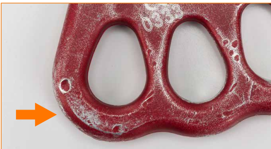
Körper mit Einkerbungen mit einer Tiefe von mehr als 1 mm.
