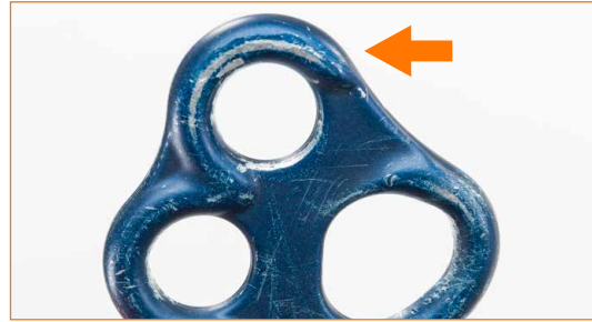
Abnutzungserscheinungen und kerben mit einer Tiefe von mehr als 1 mm.
